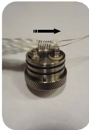
Bild 5: Mit Hilfe einer Drahtschlinge eine doppelt gelegte Ortmann-Schnur durch die Wicklung ziehen.
