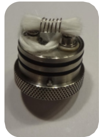
Bild 6: Die Ortmann-Schnur nun bündig mit der Außenkante vom Sockelboden abschneiden und gut mit Liquid befeuchten. Um evntl. überschüssiges Liquid vom Sockelboden aufzunehmen, empfehlen wir einen Strang der Schnur als Docht auf den Sockelboden zu legen.
