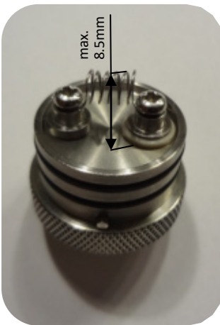
Bild 4: Hinweis: Der Abstand zwischen Oberkante Wicklung und dem Sockelboden darf 8.5mm nicht überschreiten, da diese sonst mit dem Kammerboden in Berührung kommt, was einen Kurzschluss zur Folge haben kann.
