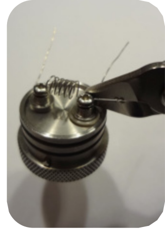
Bild 3: Mit Hilfe eines Seitenschneiders oder einem anderen geeigneten Werkzeug die überstehenden Drahtenden bündig mit den Schraubenköpfen abschneiden.
